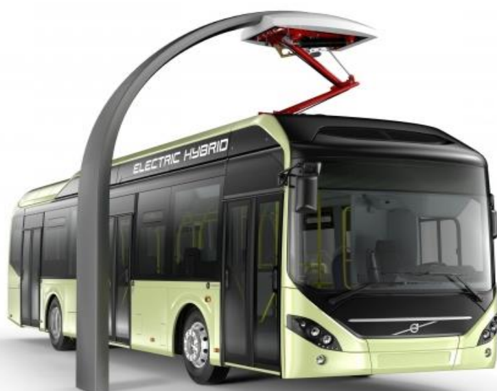
Rysunek 2. Pantografowa stacja ładowania autobusów hybrydowych
